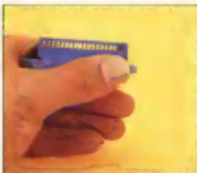
Fig. 4. Ecco come va allegato il connettore Centronics per poter inviare il testo.
